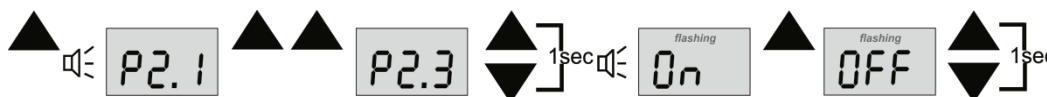
Abbildung 6. Beispiel für die Einstellung des Parameters P2.3 nach der Aktivierung des Thermometers und mit ausgewähltem Betriebsmodus F2
