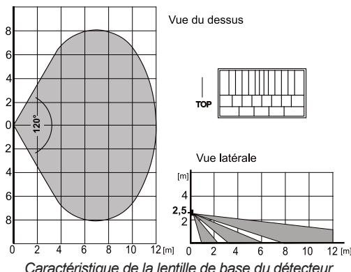
Il est possible de modifier la caractéristique en utilisant une lentille alternative:
