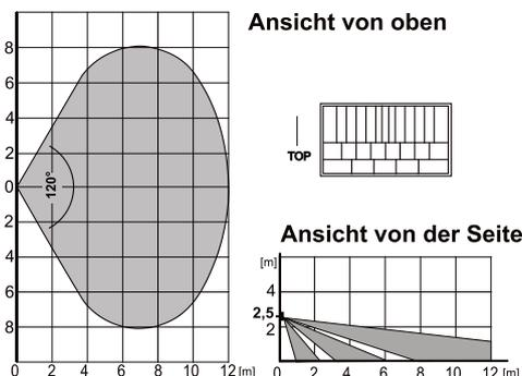
Die Charakteristik kann durch die Verwendung einer alternativen Linse verändert werden:
