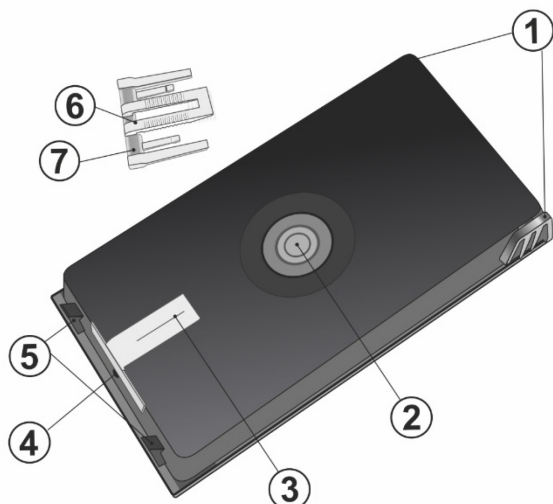
Afb. 1: Paniekknop in het montageplatform: 1. Scharnieren, 2. Knop A, 3. Schakelaar B, 4. Bevestigingsschroef voor de achterplaat, 5. Vergrendelingen voor de montageplaat, 6. Vervangbare bankbiljetten- of documentenklem, 7. LED-lichtgeleider.
