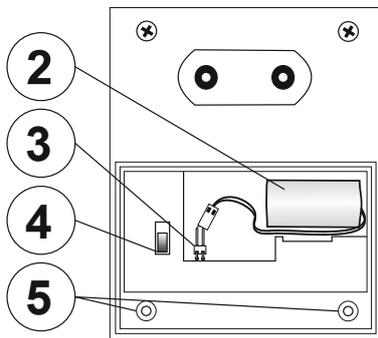
Abbildung 2: 2 – Backup-Batterie, 3 – Batterieanschluss
