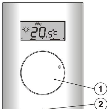
Abb. 1: 1 – Drehregler mit Taste; 2 – Abdeckungsfläche
