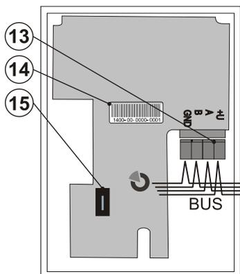
Abbildung 4: 13 – Klemmen für den BUS-Anschluss; 14 – Seriennummer; 15 – Sabotagekontakt
