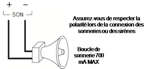
Figure 1-5 Câblage de sonnerie
