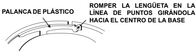
Figura 3b: Quitar la cabeza del sensor de la base
