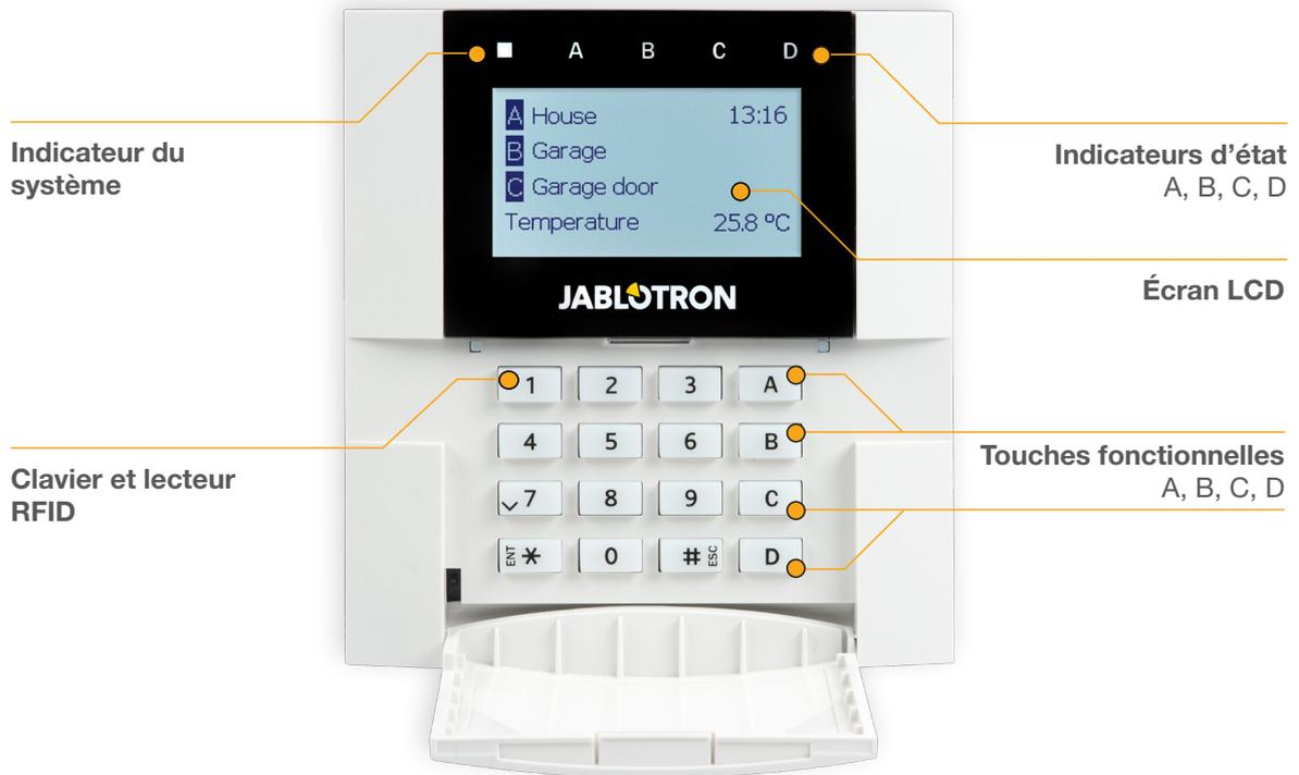
Les états des sections individuelles sont indiqués par les indicateurs d'état A, B, C, D au-dessus de l'affichage LCD et par les touches fonctionnelles. La centrale peut être utilisée directement (armement ou désarmement de l'alarme et des autres fonctions d'automatisation) en utilisant les touches fonctionnelles sur le clavier. Les touches fonctionnelles et les indicateurs d'état A, B, C, D colorés sont rétroéclairés afin d'indiquer clairement l'état de la section.
