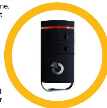
Si le système est configuré sur Armer après confirmation, le détecteur signalera l'échec de l'armement avec le voyant LED vert si un périphérique est déclenché. Il est nécessaire de confirmer l'armement en appuyant de nouveau sur la touche de verrouillage. L'armement de la section sera confirmé par un voyant LED rouge.
