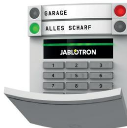
**Kartenleser mit einer Tastatur** – Der Benutzer kann das System bedienen und die Bereiche steuern unter Verwendung eines Codes oder bei der Verwendung des berührungslosen Lesers. Es kann entweder einen Code eingegeben werden, oder der berührungslose Leser mit RFID Karte / Tag verwendet werden. Für eine höhere Sicherheit ist auch die Kombination beider Methoden möglich.
