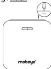
Während der Datenübertragung blinkt die LED schnell. Ein batteriebetriebenes Gerät blinkt zuerst rot/grün, bis es mit dem Netzwerk verbunden ist.
